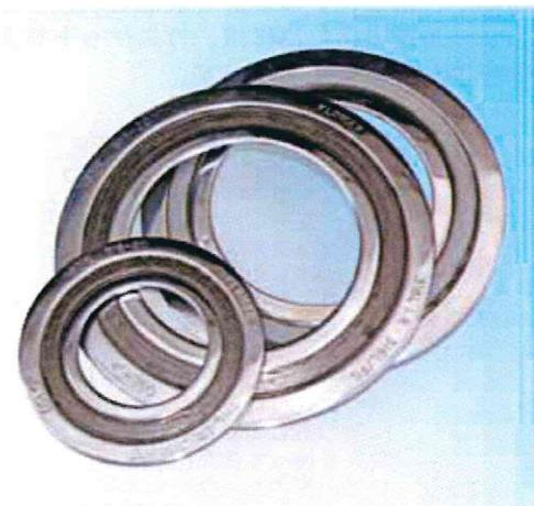
渦巻ガスケットは流体の圧力や温度変化、フランジ面の温度差、フランジローテーション、ボルト応力緩和やクリープによる負荷変動条件下において復元する能力を持ったガスケットです。ガスケットは金属製のフープと軟質のフィラーで構成され、圧縮されると密度が高まり、装着時にフランジ表面の不整部分を埋めます。金属フープはフィラーを固定し、機械的強度と柔軟性をもたらします。クリンガーマキシフレックスガスケットは条件に応じて様々な素材を用いて製造することが可能です。
