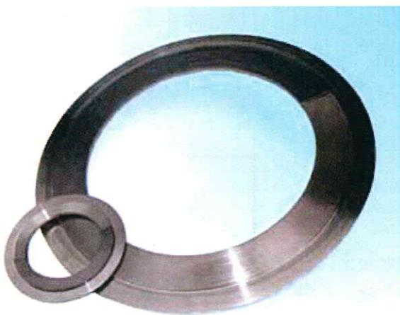
クリンガーマキシプロファイルは溝付金属本体に軟質のフィラー材を組み合わせた複合タイプのガスケットです。本体金属の両面に同心円状の溝加工が施されており、これにより圧力が高まるため、比較的低面圧においてもシールします。溝に充填された軟質フィラーによってフランジの欠陥が埋められます。金属ガスケットの高いシール性と軟質ガスケットのフランジ対応性の両方を満たすガスケットとなっています。一般的なフィラー材は膨張黒鉛ですが、流体により、PTFE、高温にはマイカも使用されます。
